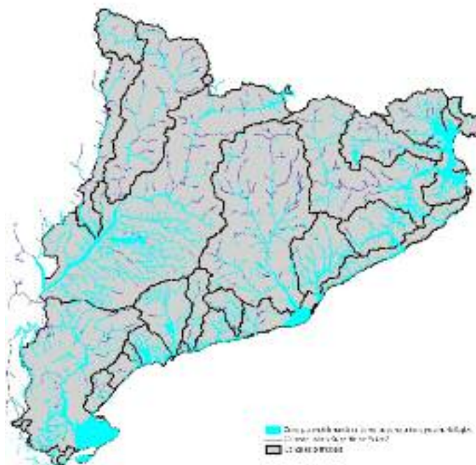
Mapa 2.9. Representació per conques hidrogràfiques principals de la informació existent de les zones potencialment inundables segons criteris geomorfològics.
