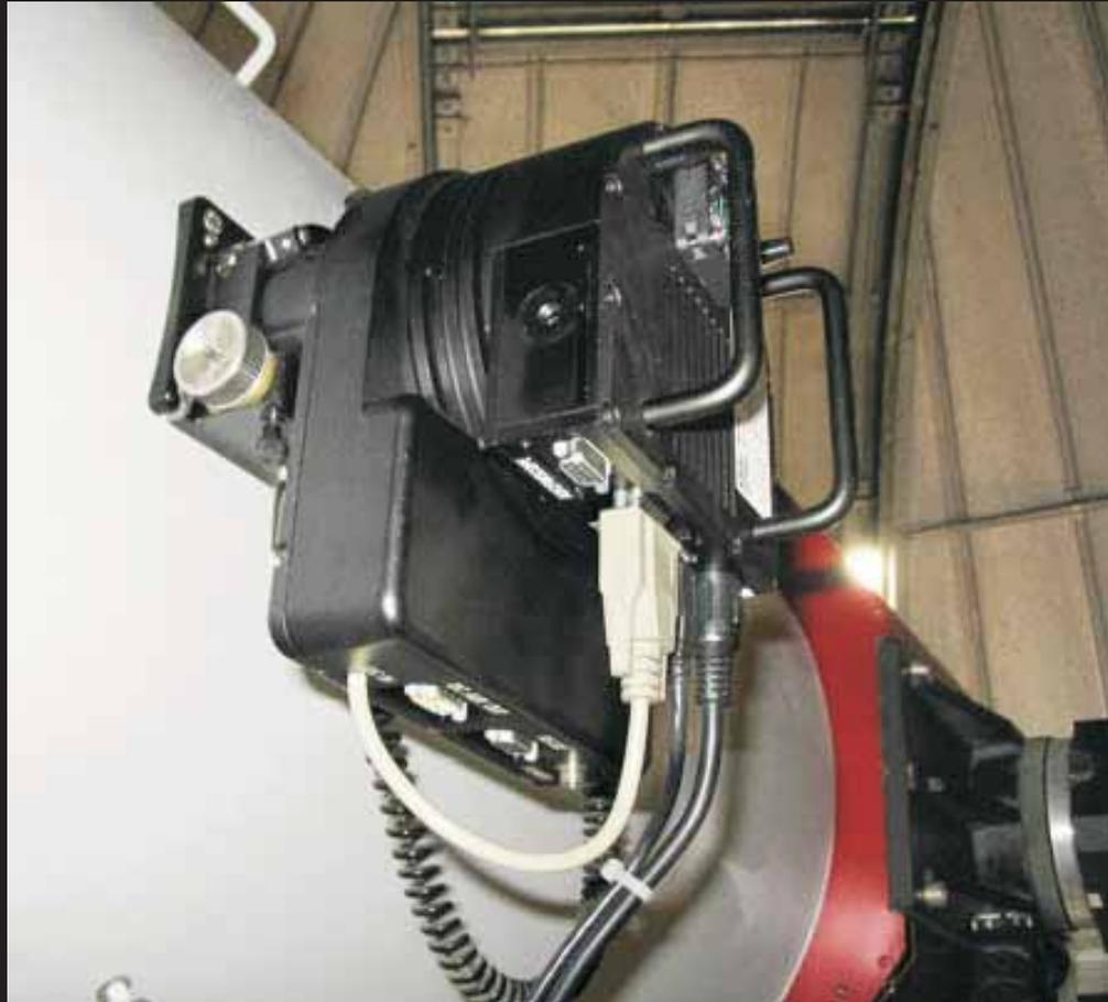
**La cámara CCD obtiene una imagen cada varios segundos o minutos, y la transmite al ordenador situado en la sala de control de Sabadell. A esta imagen el ordenador le resta imágenes de corrección de iluminación de campo (flats) y de ruido electrónico (darks).**
