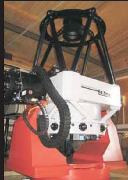
En el observatorio de Sabadell hay 4 telescopios sobre una misma muntura, pero el que utiliza generalmente para estas sesiones es un reflector de 0,5 m de abertura con doble configuración, intercambiable: Newton o Cassegrain-Relay.
