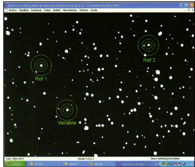
Figura 6. Programa LAIA para determinar la magnitud instrumental de tres estrellas: la variable y dos estrellas de comparación,
