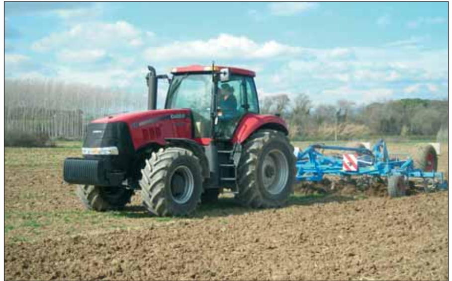
▲ Tractor de més de 300 CV en una prova a Riudellots de la Selva. Al volant una alumna de l'Escola. És un exemple de tractor molt gros, i molt car, però que treballa totes les hores que cal perquè el cost horari sigui raonable.
