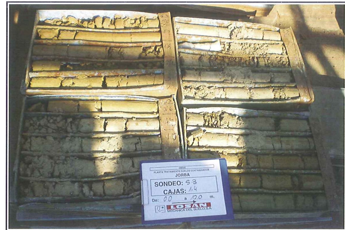
Mostres del sondeig S-3R. Caixes de 1 a 4. Profunditat de 0.00 a 12.00 m.
