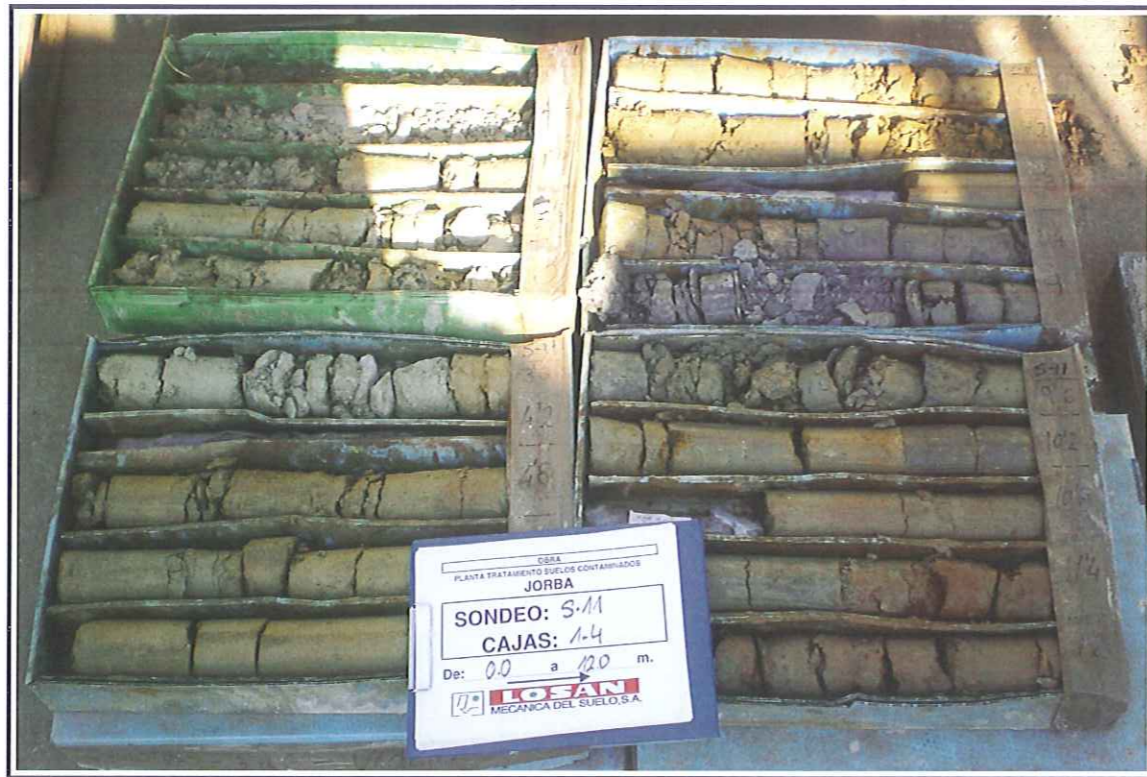
Mostres del sondeig S-11R. Caixes de 1 a 4. Profunditat de 0.00 a 12.00 m.
