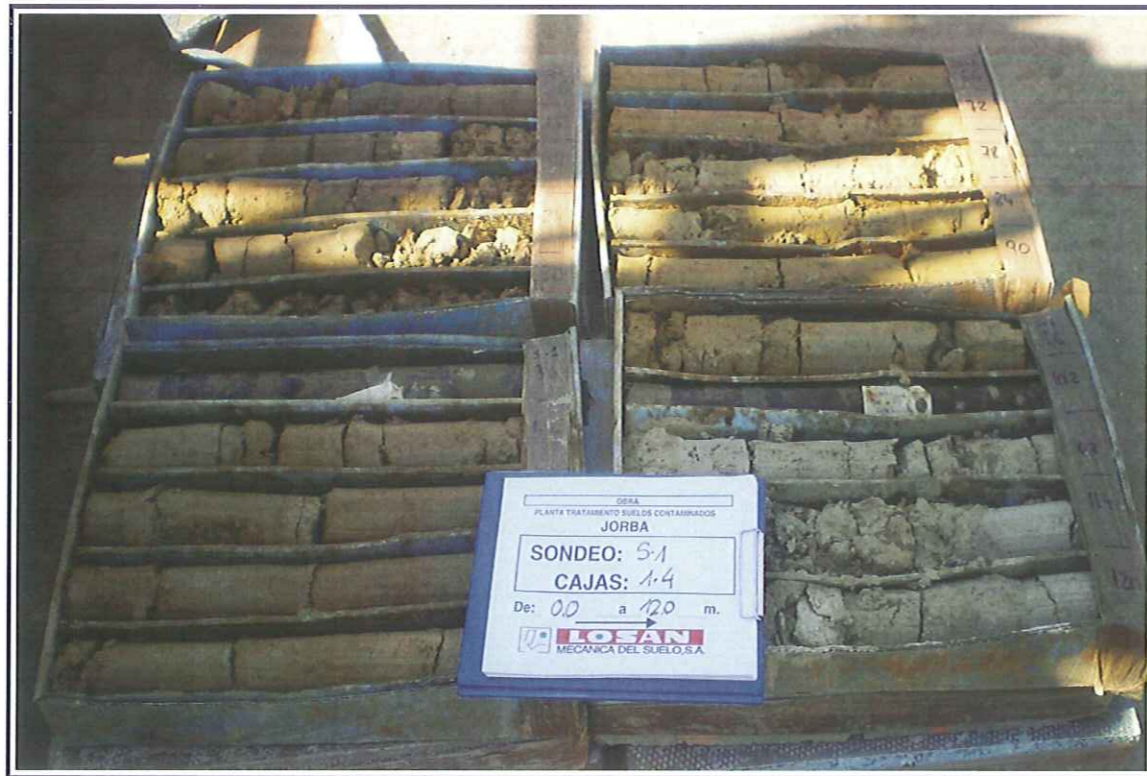
Mostres del sondeig S-1R. Caixes de 1 a 4. Profunditat de 0.00 a 12.00 m.
