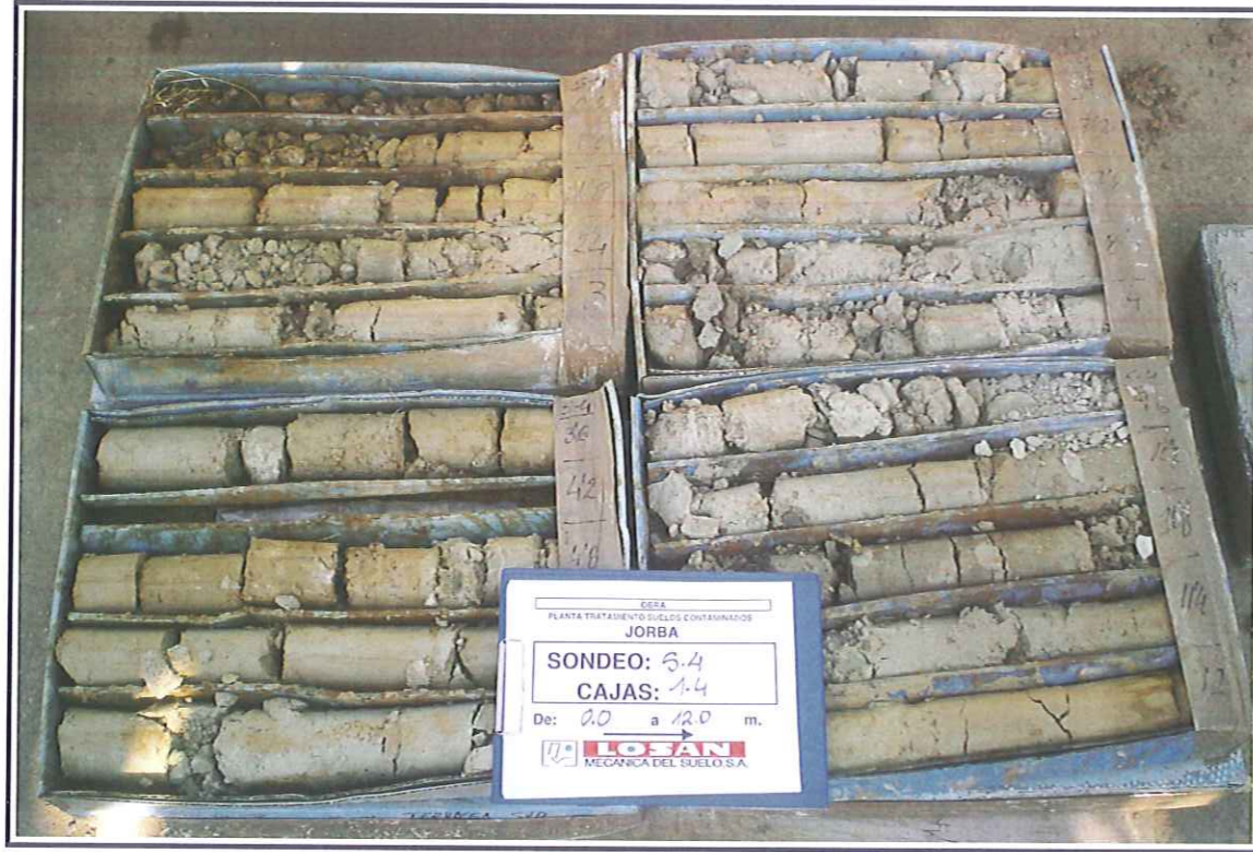
Mostres del sondeig S-4R. Caixes de 1 a 4. Profunditat de 0.00 a 12.00 m.
