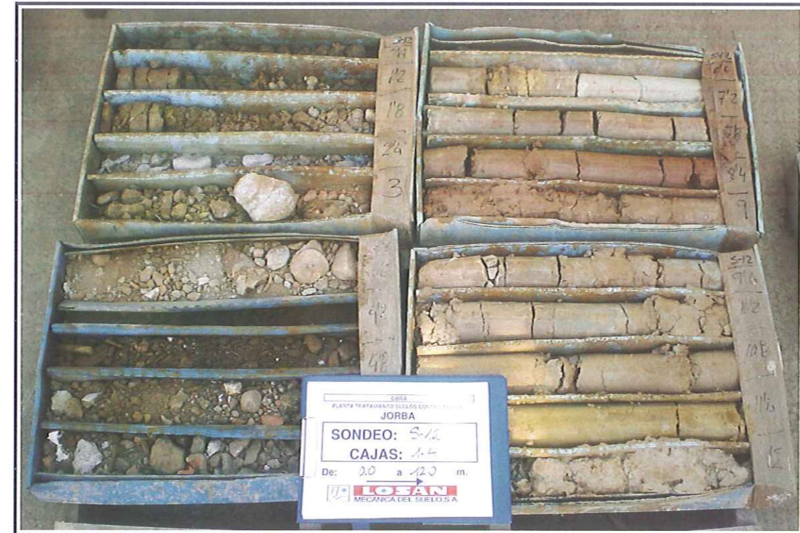
Mostres del sondeig S-12R. Caixes de 1 a 4. Profunditat de 0.00 a 12.00 m.
