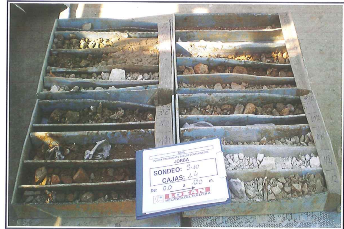
Mostres del sondeig S-10R. Caixes de 1 a 4. Profunditat de 0.00 a 12.00 m.
