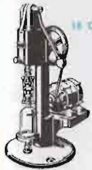
TIPO "A" SEMI-AUTOMÁTICA 1200 frascos por hora.
