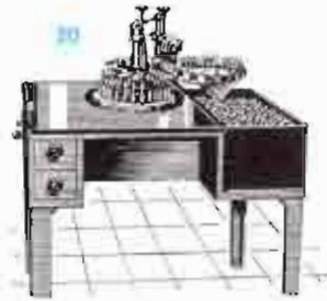
20 SOLDADORA AMPOLLAS DE INYECTABLES Dos tipos 800 a 2.900 ampollas hora.
