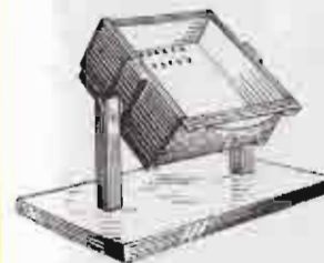
APARATO PARA LLENAR Y DOSIFICAR POLVOS en cápsulas duras de gelatina.
