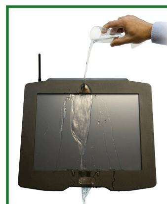
Test de resistencia al agua IP66
