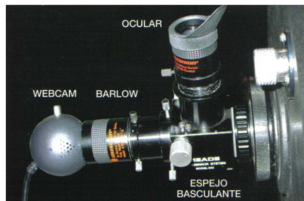
Fig. 6 - Disposición ideal para una webcam acoplada al telescopio con lente Barlow y espejo basculante.
