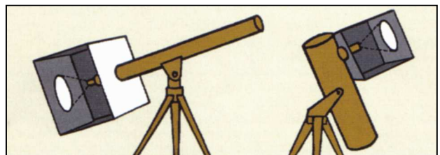
Fig. 1 - Observación del Sol por proyección en un telescopio refractor y en un reflector Newton.
