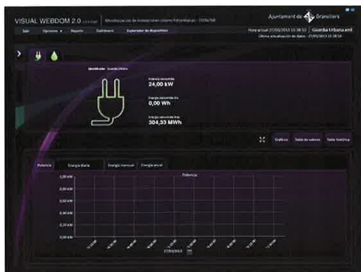
Equips d'adquisició de dades i aplicatiu per al monitoratge del consum energètic en els equipaments municipals. Font: WEBDOM, 2012.
