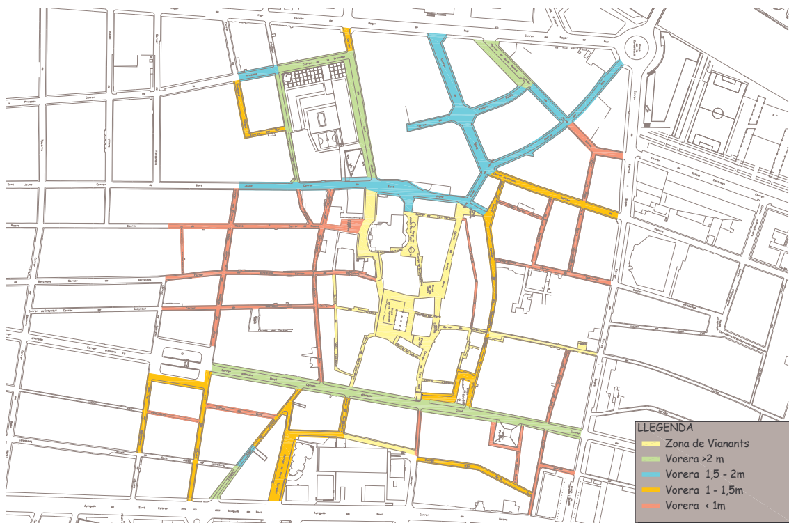
Amplada de voreres a l'entorn del centre històric (any 2006). Font: PMU
