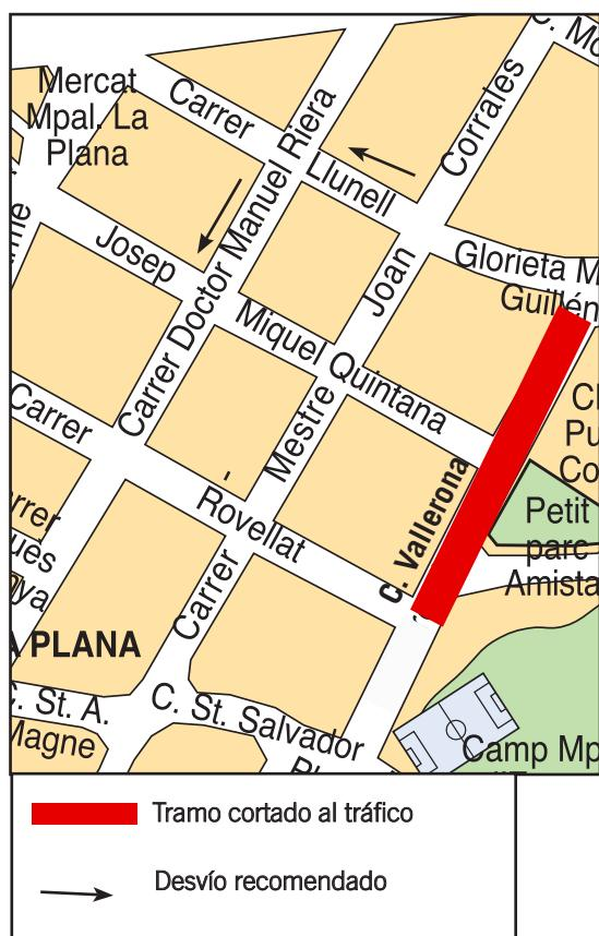
Las obras que se ejecutarán en la calle Vallerona consistirán en la anulación de los imbornales actuales y la ejecución de nuevos, la sustitución de las tapas del alcantarillado y la reparación del pavimento en las áreas de actuación. La finalidad de la actuación es paliar el ruido que producen los vehículos al pasar sobre los elementos actuales de la red de saneamiento y reparar los registros e imbornales existentes.
