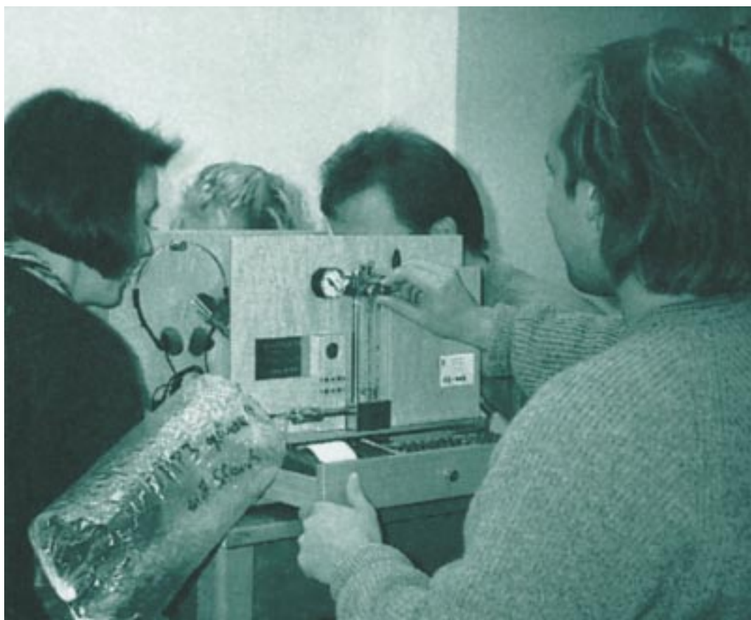
Exemple d'olfactòmetre i de panel d'avaluadors
