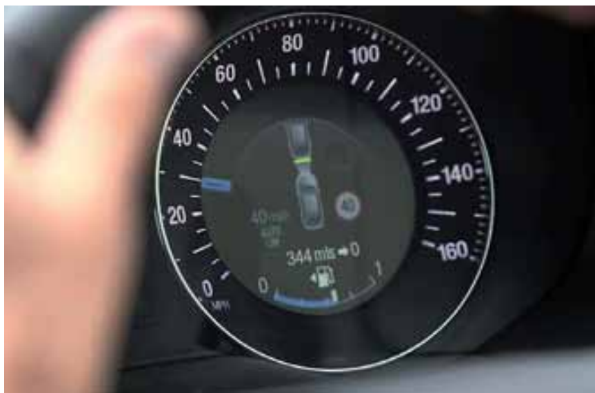
La imagen –capturada del nuevo film elaborado por ETSC– muestra la tecnología de control de velocidad inteligente (ISA) en un velocímetro que en la actualidad viene en varios modelos de coches.
