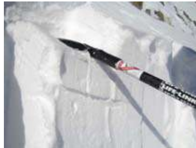
Exemple de test que no propaga. Observa la fractura iniciada sota la pala i que tira cap amunt pocs centímetres després de sortir de sota la fulla.
