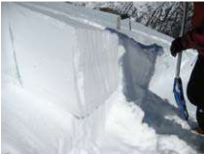
Exemple d'ECT (test de la compressió estesa) que propaga. Si la propagació s'ha produït en el mateix cop en què s'ha iniciat la fractura o just en el següent, el test és positiu i caldrà sospitar del vessant.
