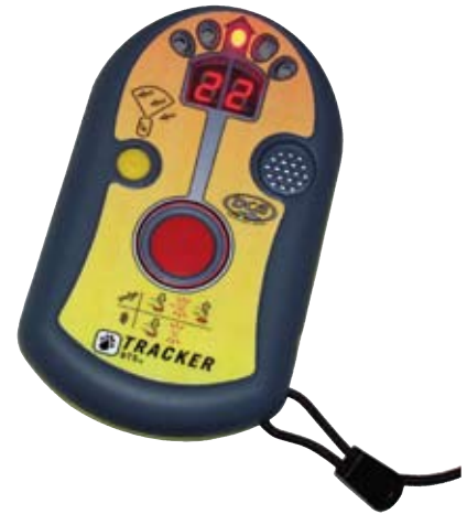
Aparell de Recerca de Víctimes d'Allau (ARVA). Enginyeria de telecomunicacions al servei dels rescats dins la neu.
