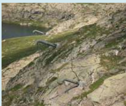
4. Dispositius de desencadenament artificial remot tipus Gazex a Les Deux Alpes, Alps francesos.
