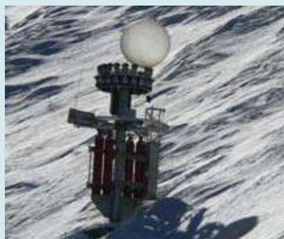
5. Dispositiu de desencadenament artificial remot tipus Avalhex a la vall de Núria, Pirineu català. (Foto: IGC.)
