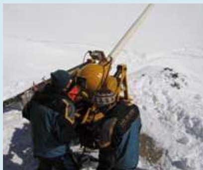
2. Desencadenament artificial mitjançant canó d'aire comprimit Avalancheur a la vall de Núria, Pirineu català. (Foto: IGC.)
