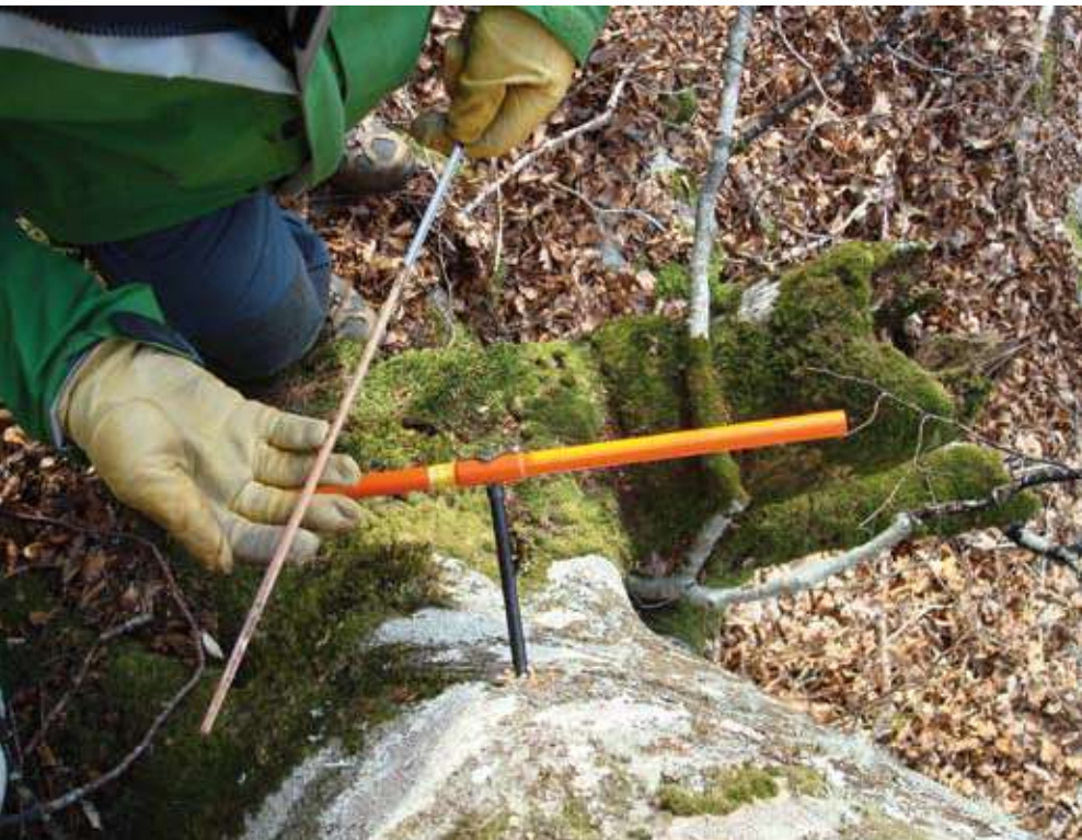
Figura 6. Extracció d'un testimoni de fusta amb barrina de Pressler. Aquest estri permet obtenir mostres dels anells de creixement del tronc de l'arbre sense haver de tallar-lo.
