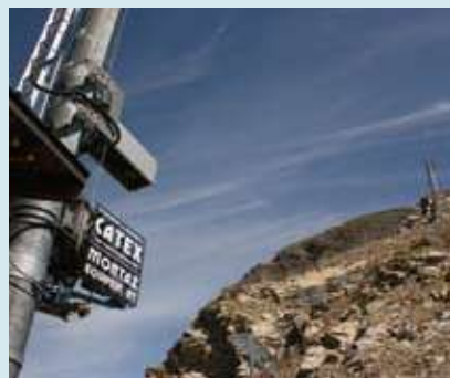
3. Dispositius de desencadenament artificial per transport d'explosiu amb cable tipus Catex a Les Deux Alpes, Alps francesos.
