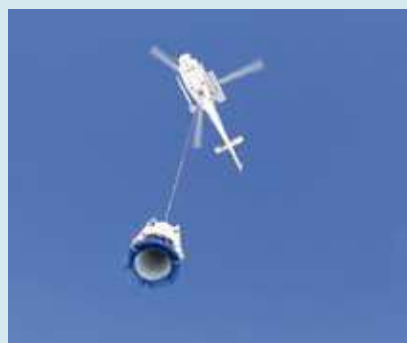
6. Dispositiu de desencadenament artificial helitransportat tipus Daysibell per a la protecció de la carretera del port de la Bonaigua, Pirineu català. (Foto: CGA.)
